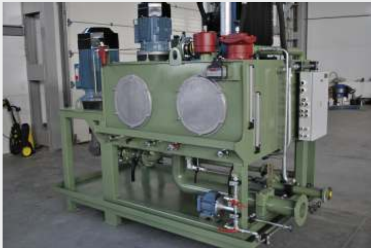
Насосная станция испытательного стенда
